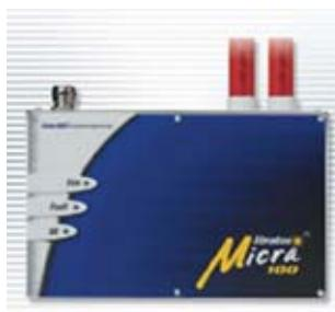
La detección por aspiración forzada es un sistema que utiliza un ventilador de aspiración para tomar muestras de aire del área protegida mediante tomas de mues-
