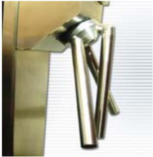
El propósito del molinete de "Brazo Caído" o "Aspas Rebatibles", es permitir la liberación del paso ante una eventual evacuación de emergencia, y facilitar la circulación de elementos de gran tamaño. Para esto, las aspas cuentan con un mecanismo que permite que se "quiebren" hacia abajo o hacia un lateral, pudiendo recuperar su posición y función normal al finalizar la situación.
