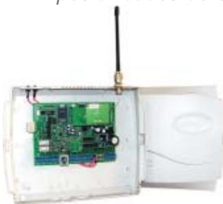
**BACK UP Celular:** Es un comunicador tradicional solo que en este producto se incluye el módulo telefónico de respaldo y el sistema transmite normalmente por línea telefónica fija, a la que constantemente está verificando. Si ésta no presentara tensión
