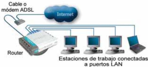
Las redes Ethernet utilizan cables de par trenzado UTP, cuya longitud de cable máxima está en torno a los 100 metros. Si es necesario conectarse a distancias superiores existen diferentes dispositivos que lo hacen posible, como la fibra óptica o las redes inalámbricas.
