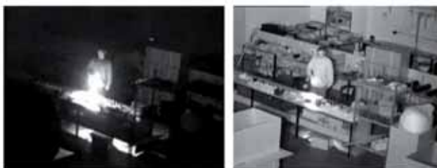
A la izquierda, imagen sin iluminador de infrarrojos. A la derecha, imagen con un iluminador.
