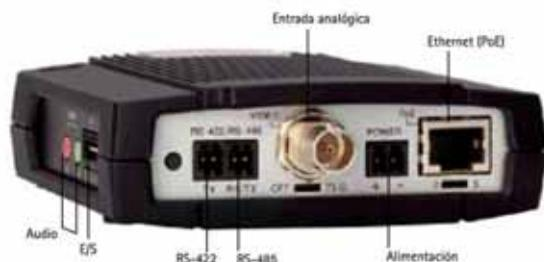
Codificador de video independiente de un canal con audio, conectores E/S (entrada/salida) para controlar dispositivos externos como sensores o alarmas, puertos de serie (RS-422 / 485) para el control cámaras analógicas PTZ y conexión Ethernet con soporte de alimentación a través de Ethernet (PoE).
