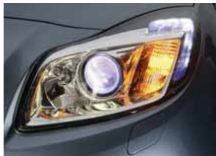
LED's aplicados al automovilismo: Vehículo con luces diurnas de LEDs
