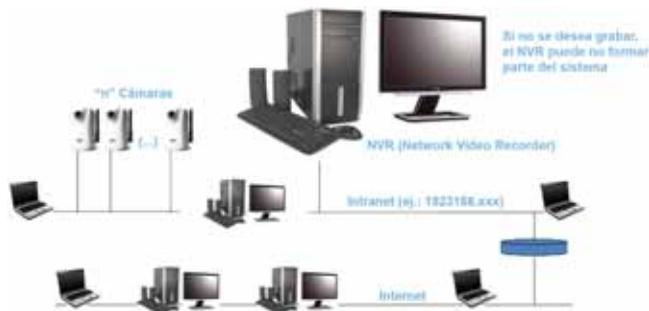
Debe notarse que la diferencia fundamental entre los sistemas radica en que las cámaras transmiten a través de un canal compartido (una red TCP/IP) y que la señal de video de las cámaras es un streaming TCP/IP. Las cámaras tienen la capacidad de codificar la señal de video por medio de algún códec que transmita audio y video a través de TCP/IP, protocolo pensado originalmente para la transmisión de datos. Entre los códecs más usuales se encuentran MJPEG, MPEG4, H.264.
