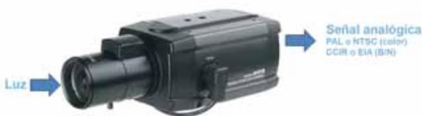
La cámara adquiere la imagen a través de un sensor CCD o CMOS y ofrece al dispositivo de visualización/grabación una señal en formato PAL o NTSC (o sus equivalentes CCIR o EIA para blanco y negro).
