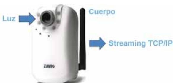
La cámara adquiere la imagen a través de un sensor CCD o CMOS y ofrece al dispositivo de visualización/grabación una señal codificada como MJPEG, MPEG-4, H.264, con dual streaming simultáneo en algunos casos (para visualizar en simultáneo en buena calidad en una intranet y en calidad ajustada al ancho de banda disponible a través de Internet)
