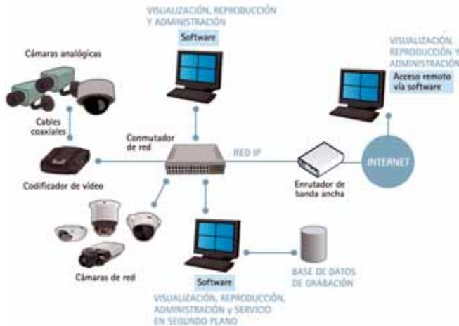
Un sistema de videovigilancia en red basado en una plataforma abierta de servidor de PC con software de gestión de video
