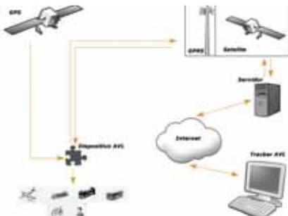
*“Los equipos generalmente posibilitan la transmisión de posiciones cada 30 segundos, señalización de eventos y telemetría. También, por medio de un software pueden enviarse telecomandos para, por ejemplo, corte de motor o la activación de accesorios compatibles con el propio software”*
