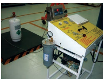
El corazón de la empresa: a través de la bomba se recarga el gas en los cilindros y se lo someten a una serie de test que decidirán la aptitud del insumo para ser nuevamente reemplazado en el mercado.
