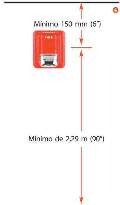
**NOTA:** Vemos muchos errores típicos en las instalaciones, donde se colocan dispositivos listados para pared sobre los techos o no se respeta la altura de montaje y se colocan sobre la pared pegados al techo. Esto limita la funcionalidad del dispositivo y no cumple con los parámetros de distribución del sonido tal cual fue diseñado. ■
