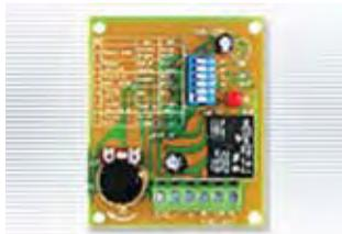
El temporizador puede programarse desde 1 segundo hasta 60 minutos. Se activa por medio de un pulso positivo o la apertura o cierre de un relay externo.
