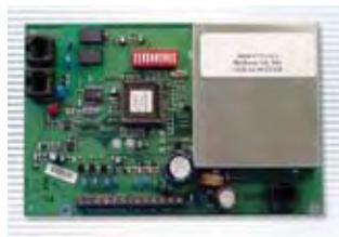
Cuando el discador digital envía un reporte, el C900TTL suministra las señales y voltajes necesarios para simular una conexión a la estación
