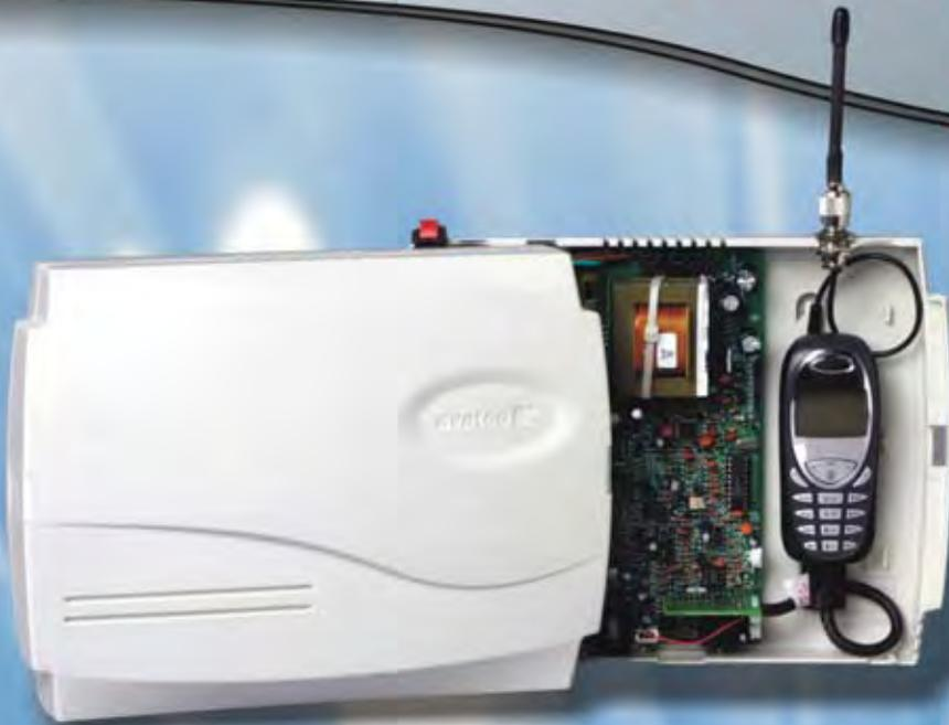
El Adaptador Celular NacCell de **avatec** permite la conexión de un terminal telefónico convencional a la red celular. De este modo, las necesidades de comunicación por voz, datos y señal de alarma -entre otros-, pueden ser rápidamente implementadas en lugares en los que el acceso a líneas convencionales es inexistente o de muy elevado costo.
