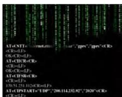
Los módulos inalámbricos son módem basados en tecnología celular GSM, programables vía comandos AT, a través de los cuales se pueden establecer comunicaciones de datos en banda ancha (EDGE), banda angosta (GPRS) y voz, de acuerdo a las necesidades del cliente.
