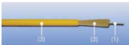
1- Fibra óptica con segunda protección 2- Cables de fibra con elementos resistentes a tracción 3- Cubierta de PVC especial (no propagador de llama y baja emisión de humo)
