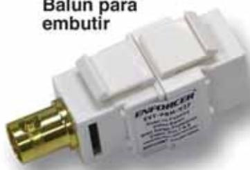
Balun pasivo con aislador de descargas a tierra
