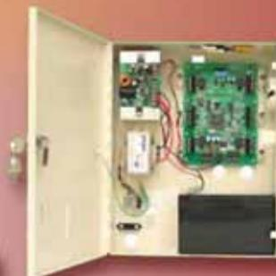
**El AC-115** es un controlador "todo en uno" compacto, potente, rápido y fácil de instalar para una sola puerta ampliable por red. Es una solución ideal para pequeñas instalaciones en red de hasta 8 puertas. Esta unidad controla hasta 2400 usuarios (Entrada/Salida) e incluye un software muy amigable que permite controlar, configurar, monitorear y emitir informes. El AC-115 incluye un parlante para timbre, alarmas y sirenas y un cargador de batería de resguardo incorporado.
