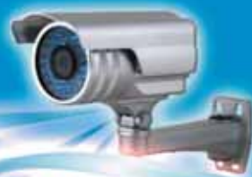
S-889FAHZ02E Cámara de 36 leds infrarrojos CCD Color 1/3" Resolución 480 TVL Leds infrarrojos hasta 50 mts de alcance efectivo Lente 4-9 mm
