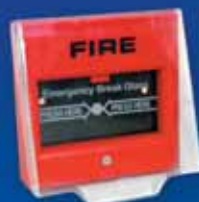
GBCP911 Pulsador manual de incendio con tapa Housing de ABS 12VDC/24VDC
