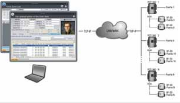
MODO RED: Configuración centralizada via LAN/WAN mediante software externo.
