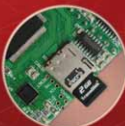
MEMORIA MICRO SD QUE ALMACENA DATOS Y CONFIGURACIÓN PARA SU FÁCIL CLONACIÓN
