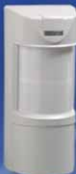
EDS 3000-TRIO Sensor para exteriores con PIR Quad y microondas Cobertura ajustable entre 90° y 180° Óptica y electrónica sellada Antienmascaramiento Salida de relé de tiempo ajustable Potente filtro de luz solar y luz blanca Inmunidad a emisiones RF Antimascota hasta 40Kg. Microondas banda K
