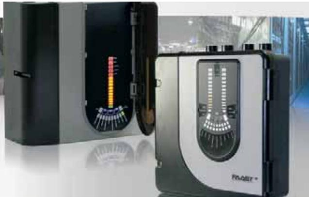
El detector de humo por aspiración de aire FAAST 8110 combina dos fuentes de detección óptica de humo con algoritmos avanzados para detectar un amplio rango de fuegos manteniendo una alta inmunidad a partículas engañosas. Esto hace que detecte con precisión condiciones de incendio de 30 o 60 minutos antes de que el fuego se desarrolle.
