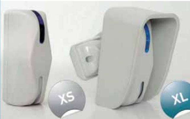
Aquarius XL y Aquarius XS son dos nuevos sensores doble tecnología de cortina, con la combinación de un infrarrojo pasivo y la funcionalidad de un microondas. El modelo XL tiene un rango de hasta 12 metros de cobertura, completamente adecuado para uso externo, mientras que el XS, con un rango de hasta 8 metros y a un costo menor, mantiene las prestaciones aunque no debe ser instalado en emplazamientos expuestos a lluvias fuertes.
