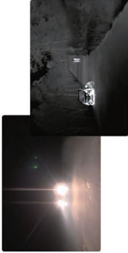
La imagen de las cámaras térmicas no se ve afectada por luz intensa, como los faros.
