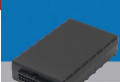
La unidad de rastreo de flota LMU-2630 ofrece características de gestión de rastreo de vanguardia, que incluye un acelerómetro de 3 ejes para controlar el comportamiento del conductor y detección de impacto del vehículo.
